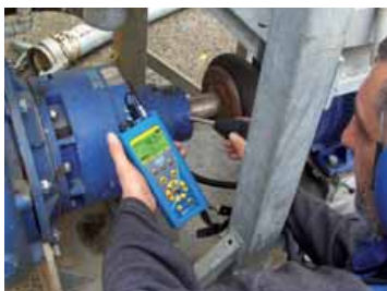
Monitoring stavu ložisek
